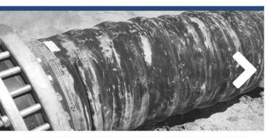
AS COMPARED TO A SINGLE EXPANSION JOINT. A MULTI LENS EXPANSION JOINT HAS A LARGER COMPRESSION AND TENSION AMPLITUDE HELPING REDUCE THE NUMBER OF SUCH JOINTS REQUIRED FOR LONG LINE SECTIONS.
